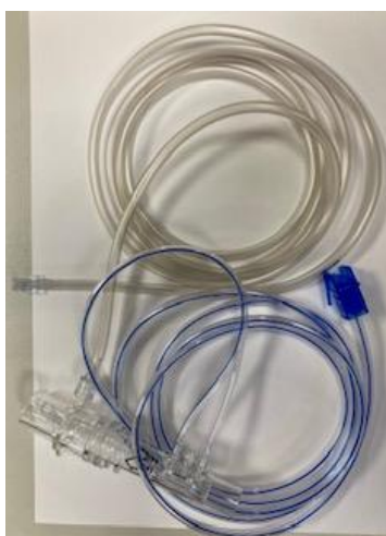
Ligne de distribution (transparente) Echantillonnage/capteur de débit (ligne bleue)
