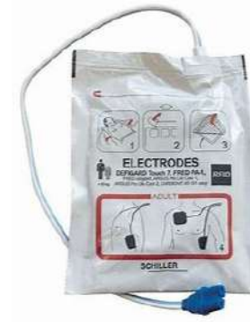
Electrodes pour défibrillateur ou stimulation externe
